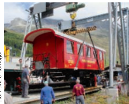
Abladen mit dem Portalkran / Déchargement avec la grue à portique
