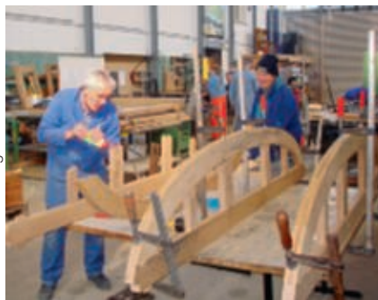
Zusammenbau der Dachbögen im Türbereich / Assemblage des arcs de toit situés près des portes
