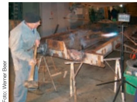
Richten des Chassis des B 2206 / Ajustage du châssis du B 2206
